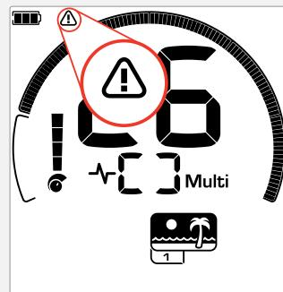
Индикатор перегрузки пляжа появляется, когда уровень передаваемого сигнала автоматически снижается.
